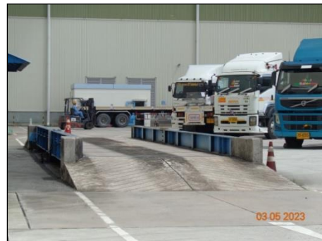
ภาพที่ 2.2-21 ด้านซังน้ำหนักรถบรรทุก
